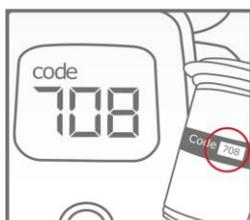
2. Ověřte, že kódovací číslo a jeho zobrazení na obrazovce přístroje i na tubě s proužky souhlasí. Vyjměte kódovací proužek. Postupujte dál, pokud se objeví symbol ☺.
