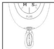
2. Zkontrolujte, zda čísla na displeji a na tubě s proužky jsou stejná. Na displeji se objeví i zkratka metody, kterou stanovujete UA nebo CHOL, GLUC a symbol kapky. Nyní otevřete tubu s proužkem pro tu metodu, kterou jste do
