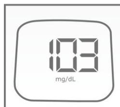
2. Pokud je reagenční zóna naplněna, přístroj pípne a začne odpočítávat měřený čas. Po kompletním ukončení se výsledek objeví na displeji a uloží se do paměti.
